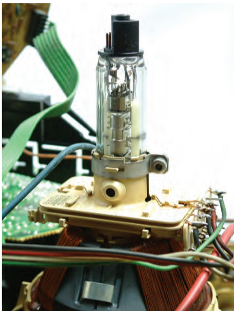
شکل ۱-۷۱-الف - شکل لامپ تصویر و پایه‌های آن
