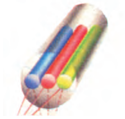
شکل ۹۳-۱- سیستم تولید اشعه In Line
