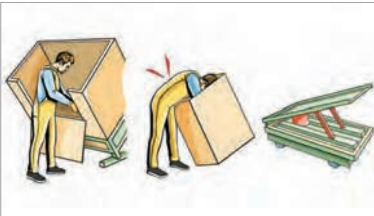
■ شکل ۳۴-۴- طراحی ارگونومیک پایه یک جعبه
