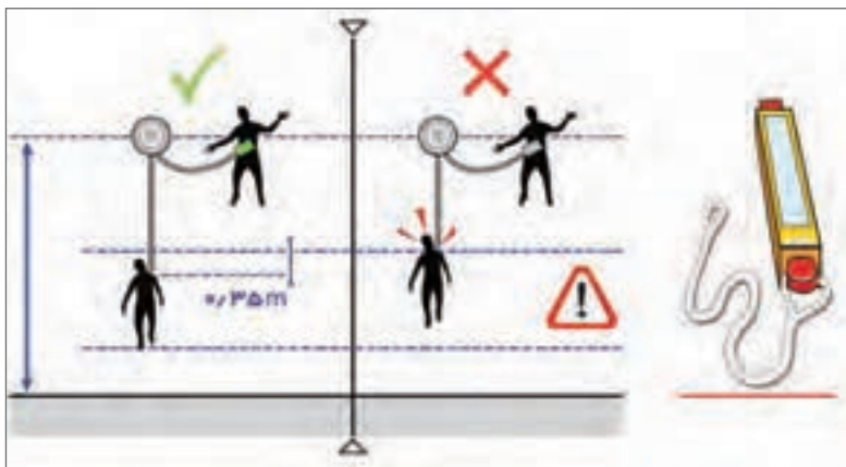
■ شکل ۱۹-۴- شوک گیر. سیستم سمت چپ دارای شوک گیر و سیستم سمت راست بدون شوک گیر (نتیجه آسیب دیدن فرد)
