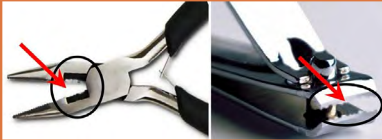
لبه های برنده خراب شده در ناخن گیر و دم باریک
