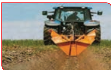
ساختن جوی های آبیاری
