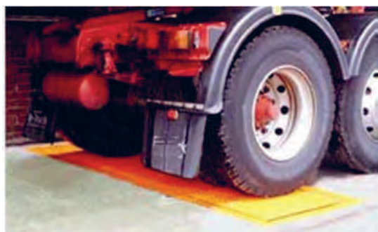
شکل ۳- باسکول محورکش ثابت
