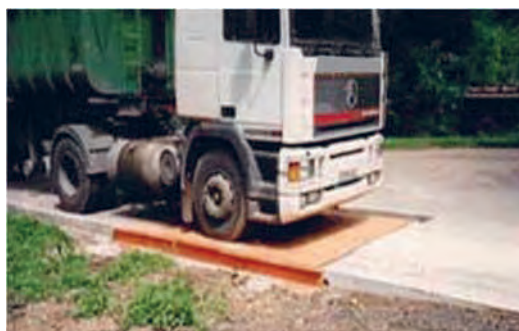
شکل ۳- باسکول محورکش ثابت
