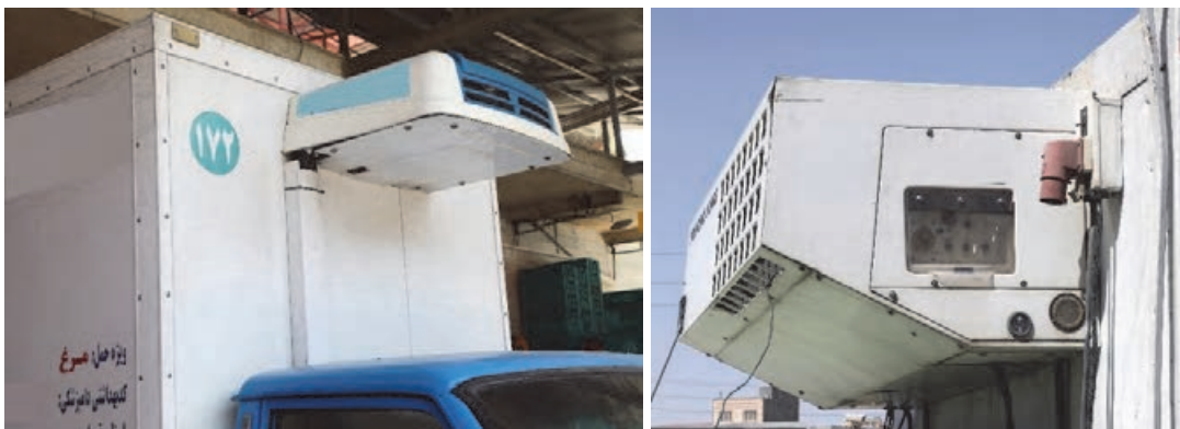
شکل ۲۱- تجهیزات سرمایشی نصب شده بر روی وسیله‌نقلیه
