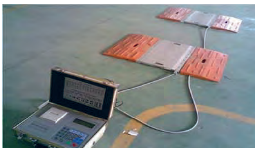
شکل ۴- باسکول محورکش متحرک
