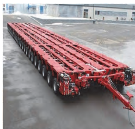
شکل ۱۴- نمونه‌ای از بوژی
