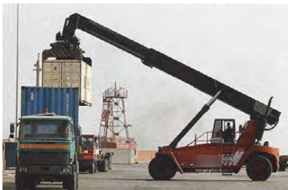
شکل ۱۲- بارگیری کامیون توسط ریچ استراکر
