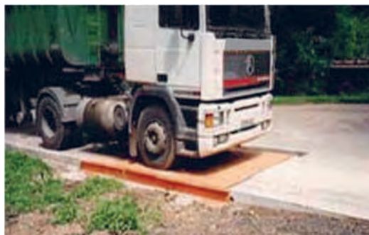
شکل ۳- باسکول محورکش ثابت
