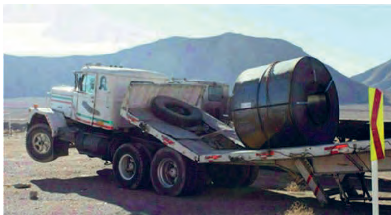
شکل ۲- عدم توزیع مناسب بار بر گروه‌های محوری
