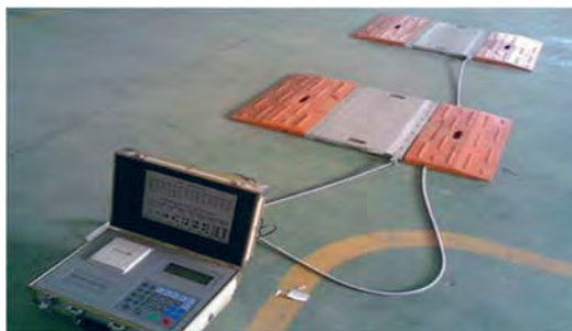
شکل ۴- باسکول محورکش متحرک
