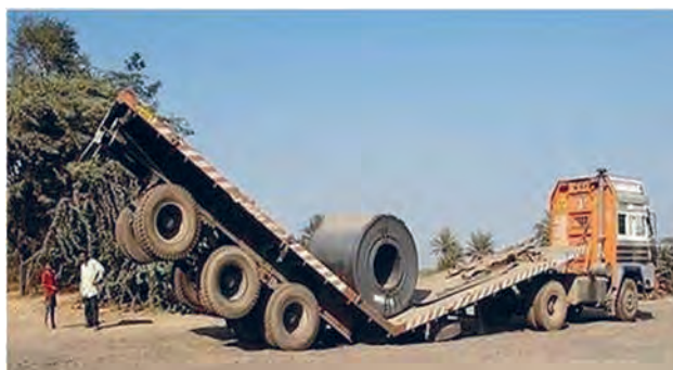
شکل ۱- بی‌دقتی در بارگیری و حمل
