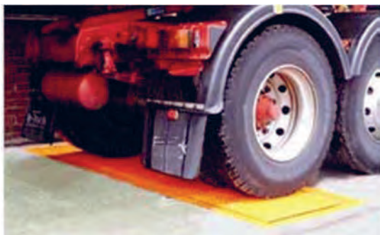
شکل ۳- باسکول محورکش ثابت
