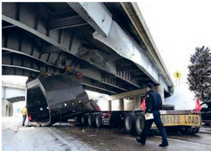
شکل ۲۶- عدم توجه به محدودیت ارتفاعی
