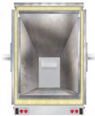
شکل ۷- اتاقک عایق‌بندی شده
