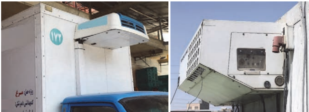
شکل ۲۱- تجهیزات سرمایشی نصب شده بر روی وسیله‌نقلیه
