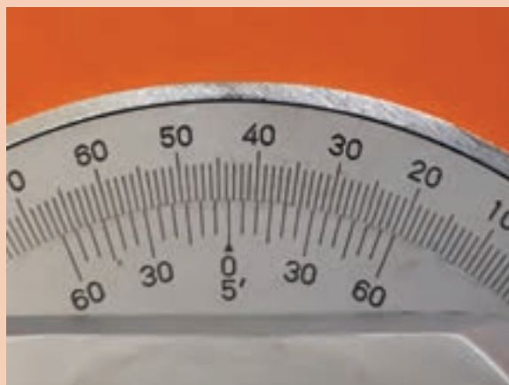
شکل ۱۴- اندازه گیری زاویه باز قطعه کار
