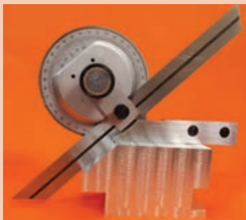
شکل ۱۴- اندازه گیری زاویه باز قطعه کار
