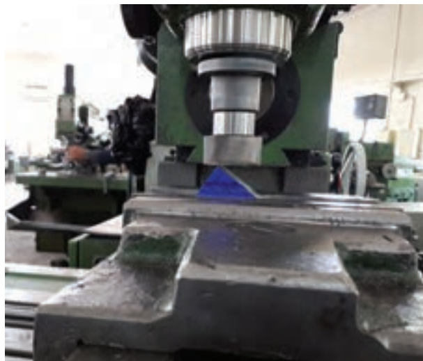
شکل ۱۷- خط کشی و بستن قطعه در گیره
