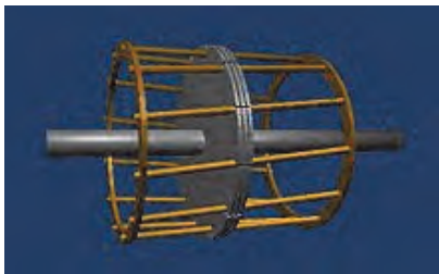
شکل ۲۱- ساختمان رتور قفسی یا قفس سنجابی
