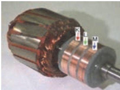
شکل ۲۲- موتور القایی رتور سیم‌پیچی
