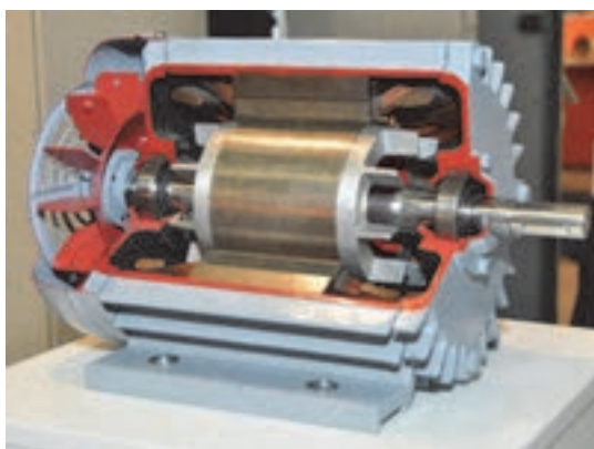
شکل ۱۳- موتور القایی سه فاز
