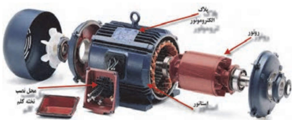
شکل ۲۷- اجزای الکتروموتور
