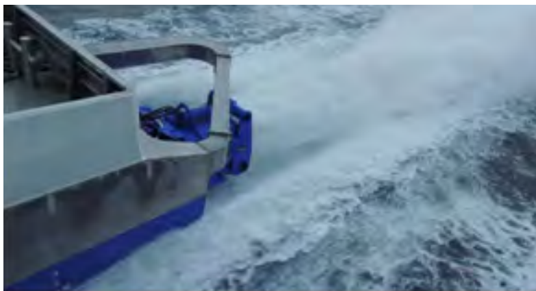
شکل ۸-۱ یک نمونه واترجت در انتهای یک شناور
