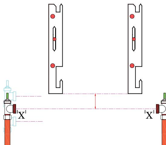
پ) روش نصب بست رادیاتور فولادی: ابتدا محل بست را مطابق شکل زیر بر روی دیوار علامت گذاری می کنیم.
