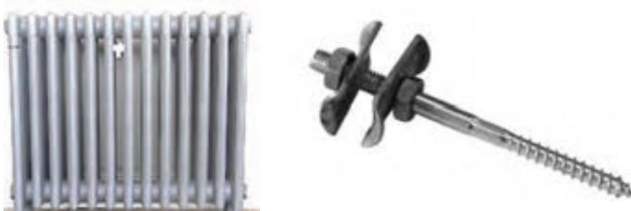
بعد از سوراخ کاری و قرار دادن رول پلاک در سوراخ، بست را که یک پیچ دوسر رزووه است در داخل رول پلاک سفت کرده و طرف دیگر آنکه از داخل پره های رادیاتور بیرون آمده توسط دو صفحه نگه دارنده و دو مهره در دو طرف رادیاتور سفت می نماییم.
