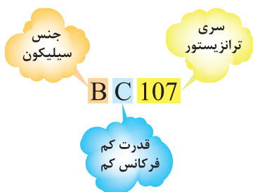
شکل ۳۱-۱۴- مشخصات ترانزیستور BC۱۰۷
