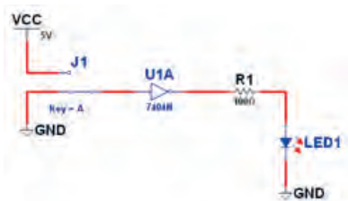
شکل ۵۹-۶ مدار گیت منطقی NOT
