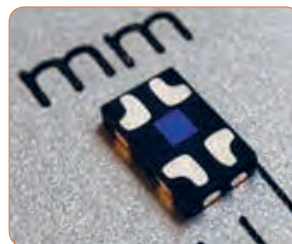
شکل ۴۱-۶ یک نمونه سنسور بدون تماس
