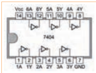
شکل ۵۸-۶ نمای ظاهری و مدار داخلی آی‌سی ۷۴۰۴
