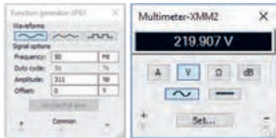
شکل ۳۹ - ۴ شبیه‌سازی ولتاژ برق شهر
