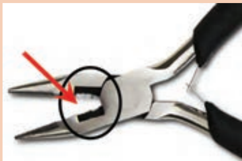
شکل ۱۸-۵- لبه‌های برنده خراب شده در ناخن‌گیر و دم‌باریک
