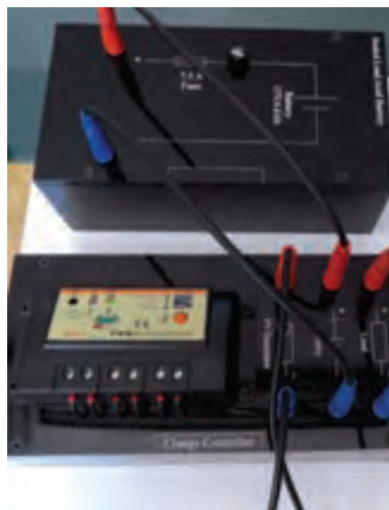
شکل ۲-۳۷ و ۱-۳۷ اتصال کنترل شارژ به مدول
