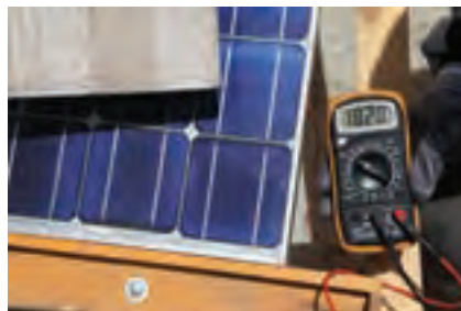
شکل ۷- الف - اثر سایه بر ولتاژ بی‌باری
