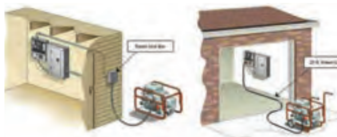
شکل ۱۲- محل اتصال موتور ژنراتور به تابلوی اصلی
