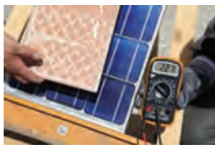
شکل ۷- ب - اثر سایه بر جریان اتصال کوتاه
