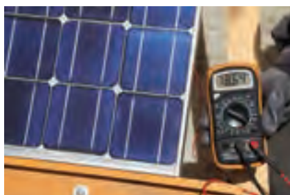
شکل ۷- الف - اثر سایه بر ولتاژ بی‌باری
