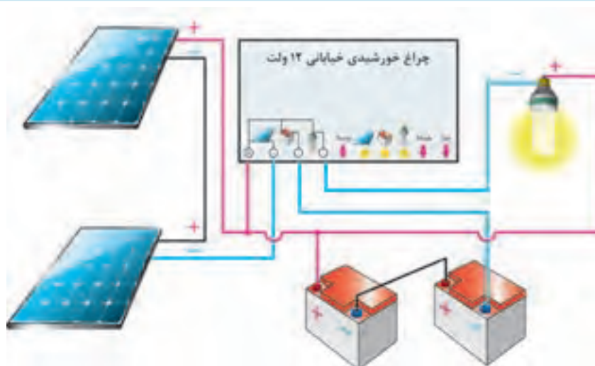
شکل ۵۲- چراغ خورشیدی خیابانی ۲۴۷ طراحی اتصال کابل
