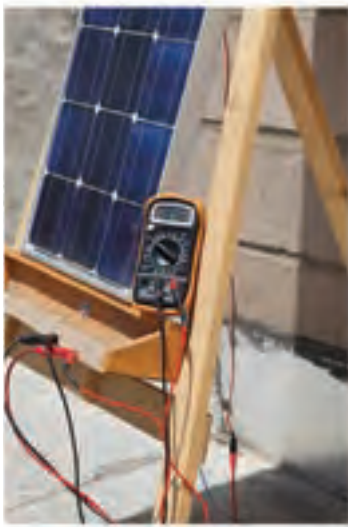
شکل ۱۵-۱ اندازه‌گیری ولتاژ بی‌باری
