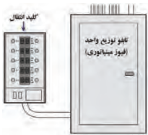
شکل ۱۵ - اتصال کلید چنج آور و تابلوی اصلی
