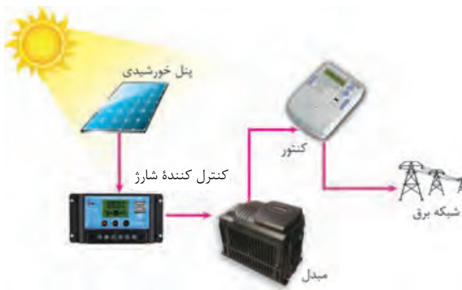
شکل ۵۱- نقشه ارتباط عناصر سیستم فتوولتائیک On_Grid
