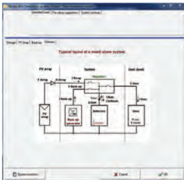
شکل ۳۹- شمای فنی پیشنهادی سامانه جدا از شبکه
