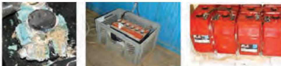
شکل ۲۱- سولفاته و نشستی باتری
