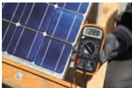
شکل ۷- ب - اثر سایه بر جریان اتصال کوتاه
