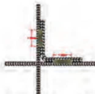
نحوه جوشکاری میلگردهای شمای یا شالوده به ستون (میلگردهای افقی به عمودی)
