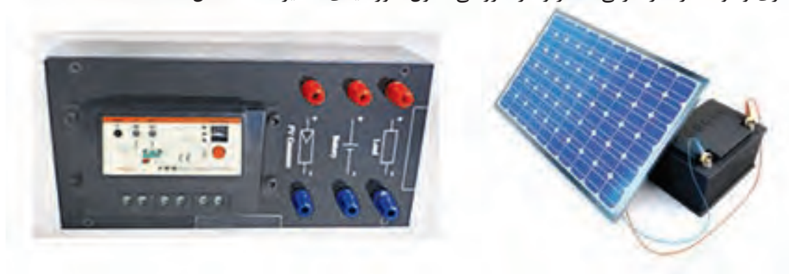
شکل ۱۳- اتصال مستقیم باتری به مدول
