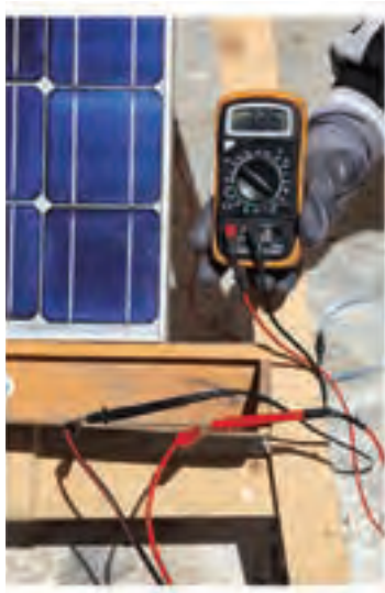
شکل ۱۵-۲ اندازه‌گیری جریان اتصال کوتاه
