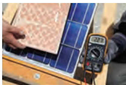
شکل ۷- ب - اثر سایه بر جریان اتصال کوتاه
