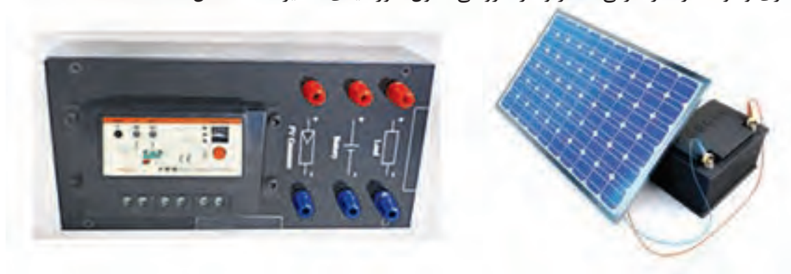
شکل ۱۳- اتصال مستقیم باتری به مدول
