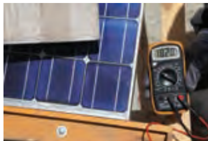
شکل ۷- الف - اثر سایه بر ولتاژ بی باری
