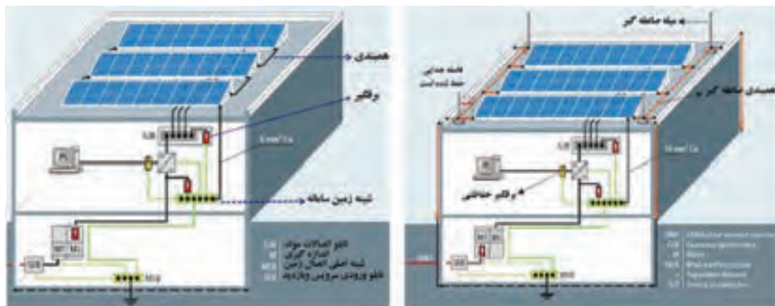
شکل ۲۲- اتصال برق گیر و همبندی با اتصال زمین
