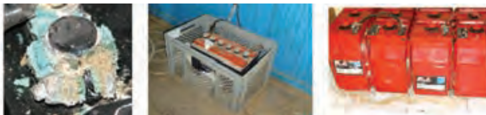
شکل ۲۱- سولفاته و نشستی باتری
