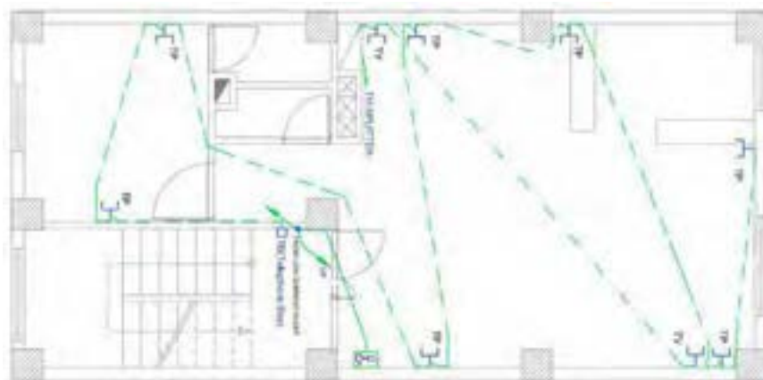
شکل ۱۰ - نقشه سیم‌کشی پریز تلفن و پریز آنتن
