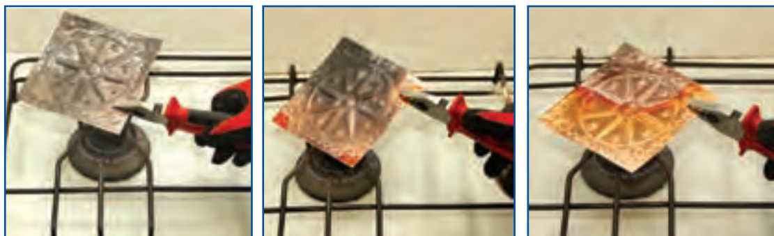
شکل ۸-۱- حرارت دادن پلاک مسی
