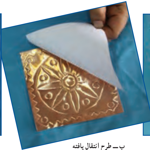
شکل ۴-۱-۰ نحوه انتقال طرح روی ورق مسی
