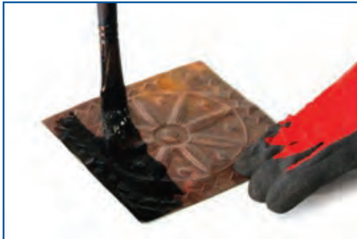
شکل ۱۰-۱۰- آغشته کردن سطح پلاک مسی به قیر
