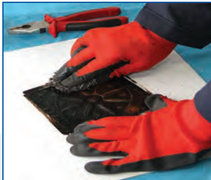
شکل ۱۱-۱۰- ساب زدن سطح پلاک مسی
