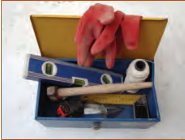
شکل ۱۰-۷- برخی از ابزار مورد نیاز دیوار چینی
