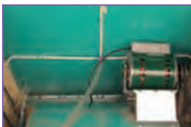
ح - آزمایش صحت مدار آب پخش کن
