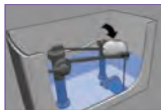
پ - اطمینان از بسته بودن کامل درپوش لاستیکی و اتصال زنجیر به آن
