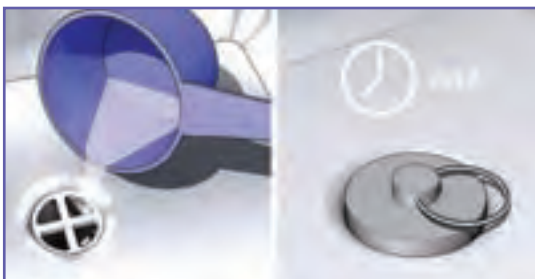
ت – ریختن مقداری آب داغ (حدود دو لیوان) پس از پنج دقیقه
