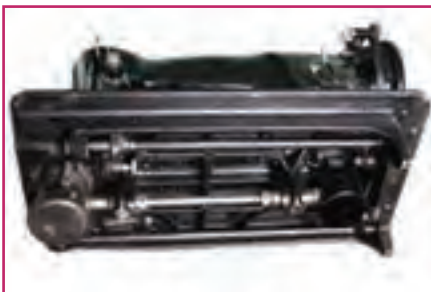
ب- ساز و کار حرکتی بادامک در ماشین دوخت
