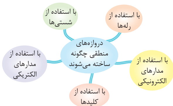
شکل ۱۷-۴- وسایل مورد استفاده در ساخت دروازه‌های منطقی
