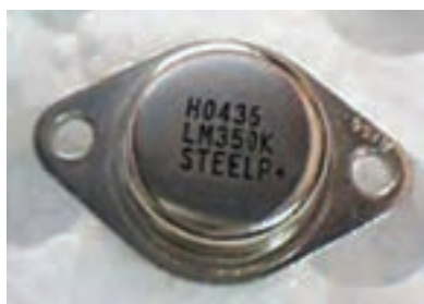
شکل ۵۵-۱- آی سی رگولاتور قابلمه ای
