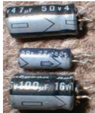
شکل ۳۸-۱ خازن‌های الکترولیتی با ظرفیت بالا
