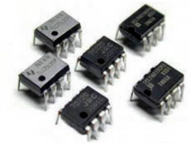
شکل ۴-۵۶- چند نمونه آی سی دروازه منطقی
