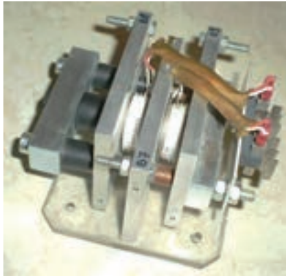
شکل ۳-۳- تریستورهای دیسکی همراه با گرماگیر
