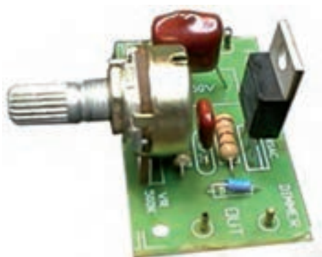
شکل ۵۵-۳- مدار ظاهری یک دایمر روشنایی
