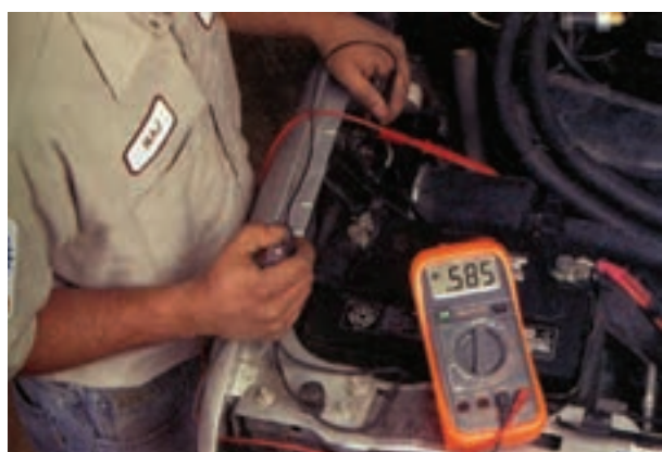
شکل ۸-۴۴ اندازه‌گیری افت ولتاژ پلاتین‌های سولونوید استارتر
