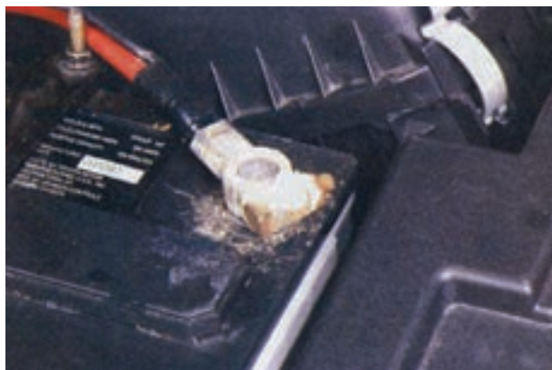
شکل ۸-۳۱ سولفات شده شدن اتصال قطب باتری
