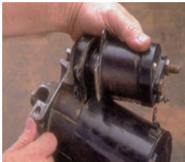
شکل ۸-۵۴ – خارج کردن اتومات
