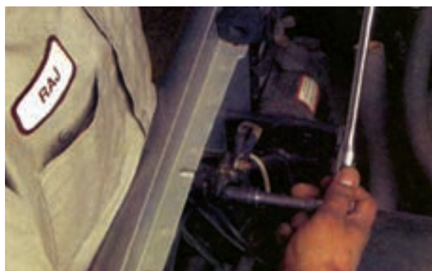
شکل ۸-۴۵ - اندازه‌گیری افت ولتاژ رله‌ی استارتر
