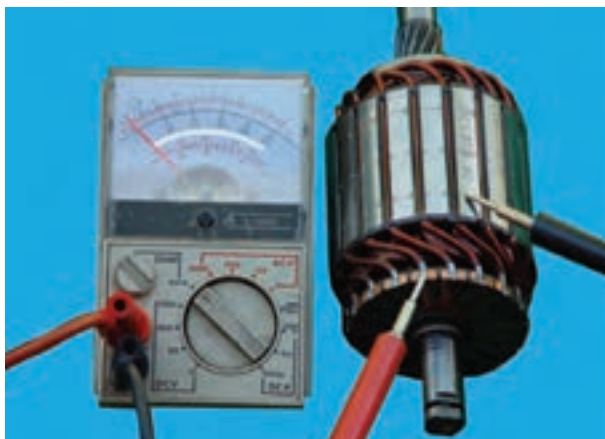
شکل ۸-۶۷ — آزمایش اتصال کوتاه شدن آرمیچر
