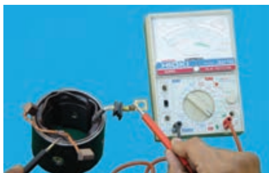
شکل ۸-۷۵ - آزمایش اتصال بدنه‌ی بالشتک
