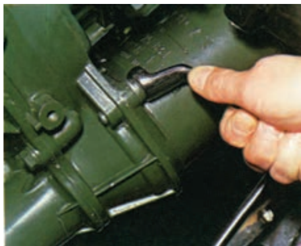
شکل ۸-۷۶ - بستن استارتر روی موتور
