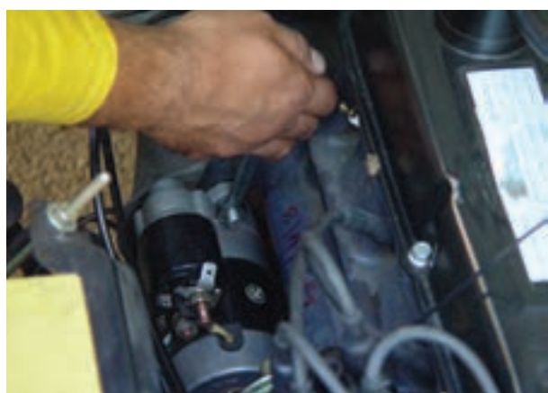
الف – باز کردن پیچ‌های استارتر
