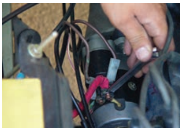
شکل ۸-۴۸ – جدا کردن اتصالات الکتریکی استارتر
