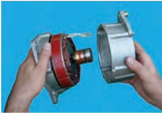
شکل ۶۱-۷ – جدا کردن درپوش‌های آلترناتور
