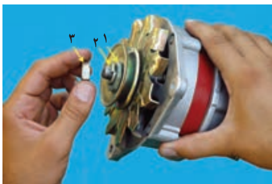
۱- واشر شش گوش ۲- واشر فتری ۳- مهره شکل ۵۷- باز کردن مهره ی پولی
