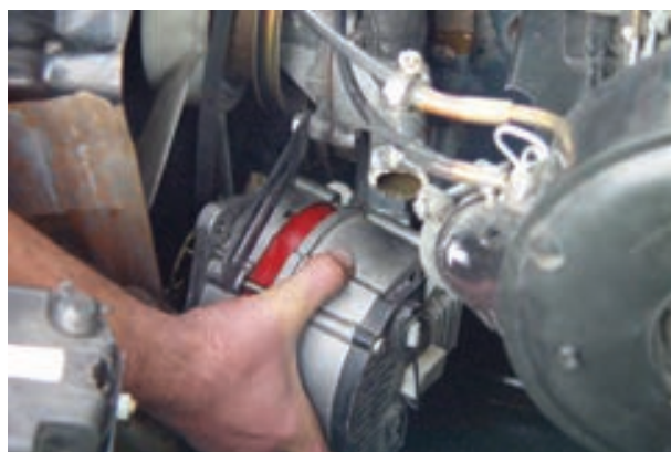
شکل ۸۶-۷- نصب آلترناتور
