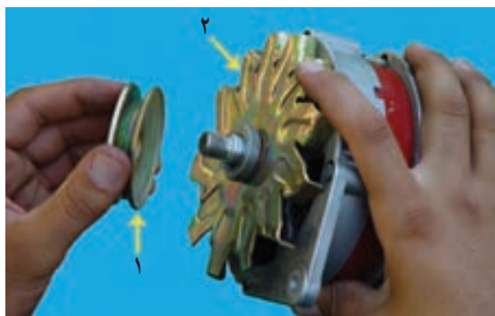
۱- پولی ۲- واشر فاصله برکن شکل ۵۸- جدا کردن پولی آلترناتور
