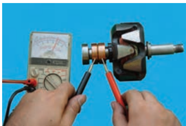
شکل ۷-۷۵ - آزمایش سالم بودن سیم پیچ روتور
