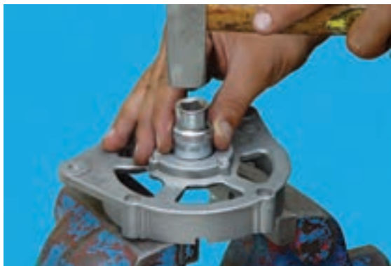
شکل ۶۹-۷ - بیرون آوردن بلبرینگ
