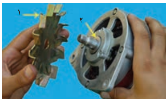
۱- پروانه ۲- واشر تکیه گاه پروانه شکل ۵۹- جدا کردن پروانه خنک کن
