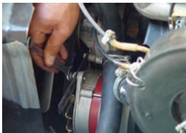
شکل ۷-۴۹ - باز کردن پیچ کشش تسمه پروانه
