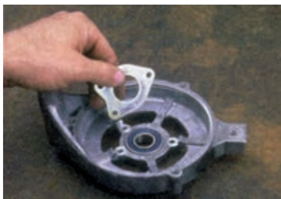
شکل ۶۸-۷ - در آوردن نگه‌دارنده‌ی بلبرینگ
