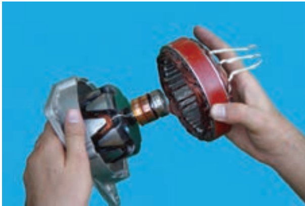
شکل ۶۲-۷ – جدا کردن استاتور
