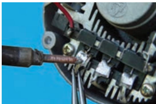
شکل ۷-۵۶- جدا کردن سیم‌های استاتور از یک‌سوکننده
