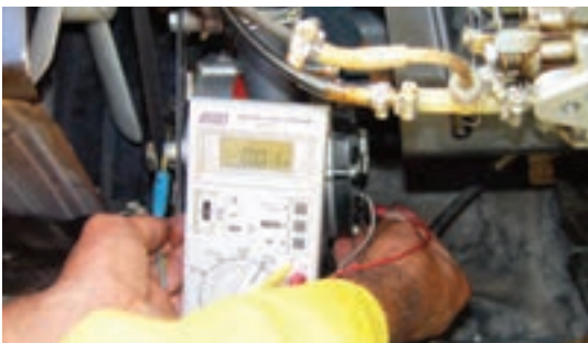
شکل ۷۲-۷۱ - اتصال ولت‌متر بین ترمینال B و بدنه
