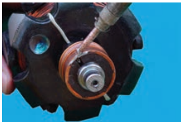
شکل ۶۶-۷ – جدا کردن سیم های روتور از کلکتور
