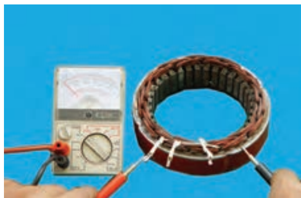
شکل ۷-۷۸ — آزمایش اتصال بدنه نبودن سیم پیچ استاتور
