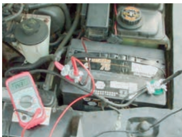
شکل ۷-۱۲- اندازه‌گیری ولتاژ شارژ
