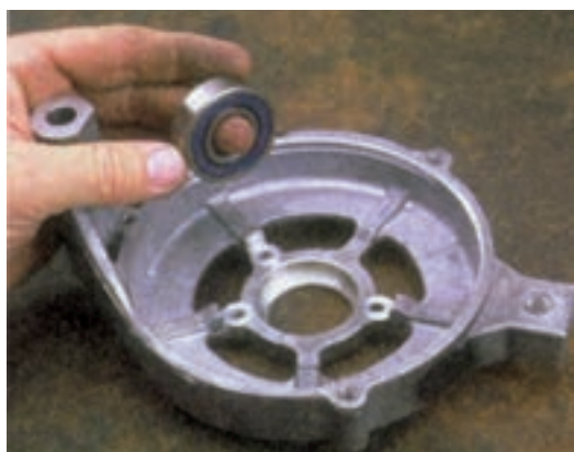
شکل ۷۰-۷ - خارج کردن بلبرینگ و آزمایش آن
