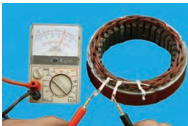
شکل ۷-۷۹ — آزمایش سالم بودن سیم پیچ استاتور
