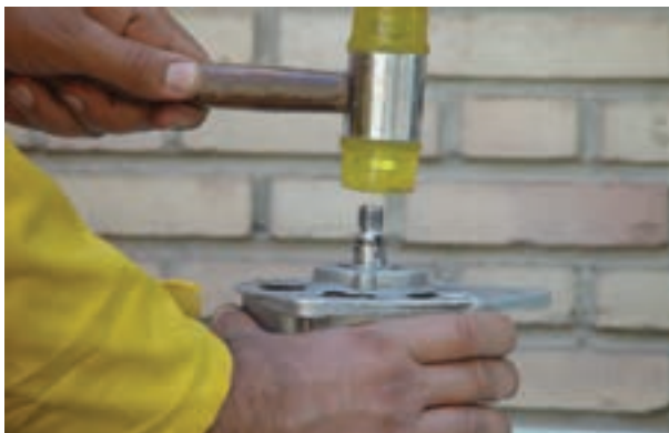
شکل ۶۳-۷ – بیرون آوردن روتور از درپوش
