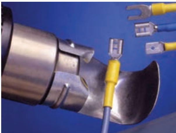
شکل ۶-۳۱ عایق‌کاری محل اتصال سیم و سرسیم
