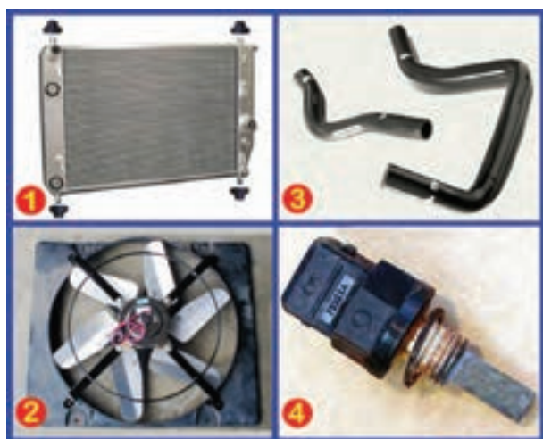
شکل ۲-۶- اجزای مدار خنک کاری
