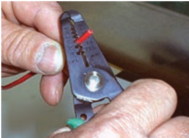
شکل ۶-۳۰ جدا کردن عایق سیم
