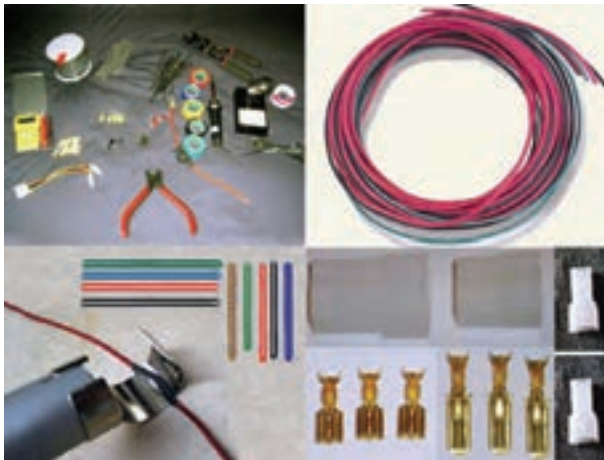
شکل ۶-۲۹ تعدادی از وسایل سیم‌کشی
