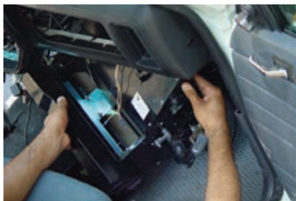
شکل ۴-۳۴- خارج کردن بخاری از محل نصب آب
