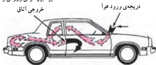
شکل ۴-۱۱- مسیر عبور جریان هوای گرم در خودرو
