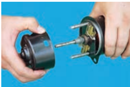
شکل ۴۵-۴ جدا کردن پوسته‌ی موتور
