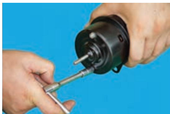
شکل ۴-۴۴ باز کردن پیچ‌های پوسته‌ی موتور
