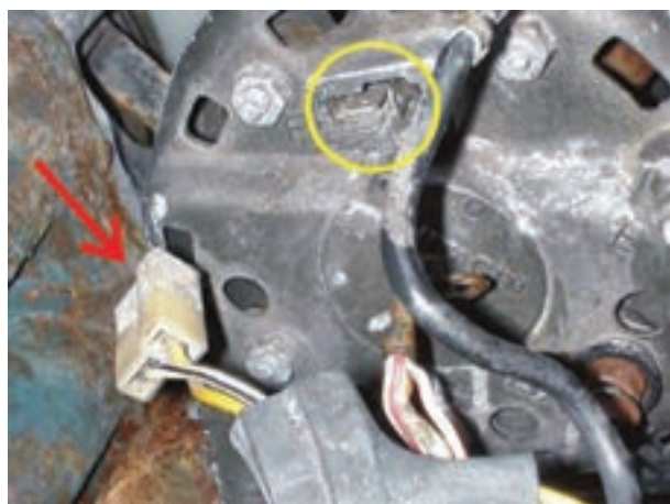
شکل ۳-۳۵ جدا کردن کاتوچویی سیم کشی لامپ شارژ
