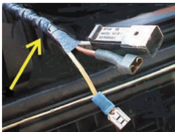
شکل ۳-۳۹- کلاف‌بندی سیم‌ها
