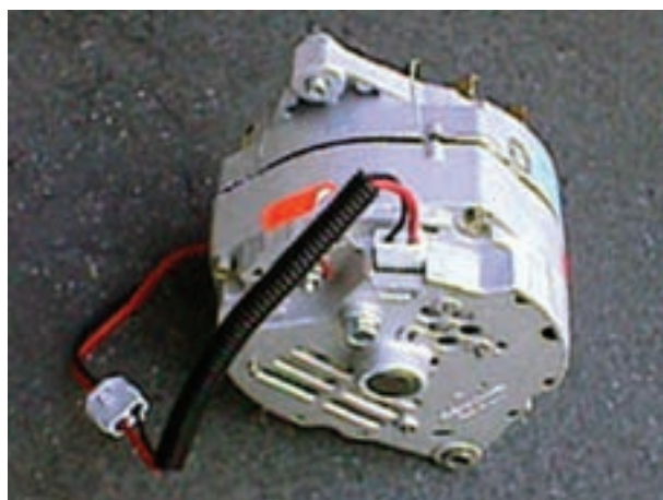
شکل ۳-۱۶- آلترناتور مجهز به آفتامات الکترونیکی
