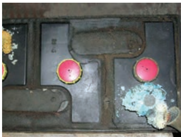
شکل ۱-۷۹ – سولفاته شدن قطب باتری
