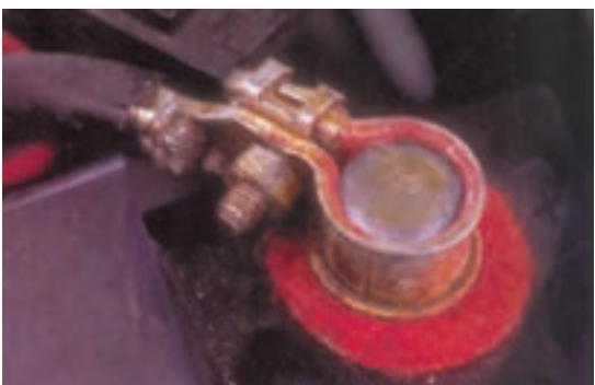
شکل ۱-۹۷- گریس زدن بست قطب‌ها
