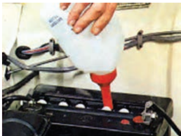
شکل ۱-۷۴- کنترل سطح الکترولیت
