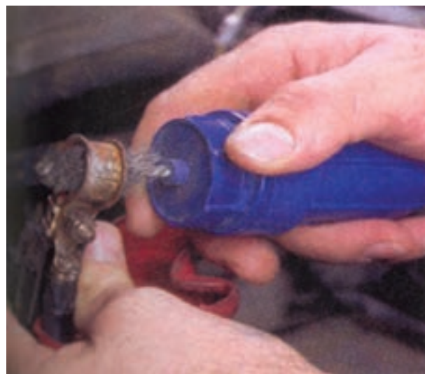
شکل ۹۱-۱ - پاک کردن بست‌های باتری با برس سیمی
