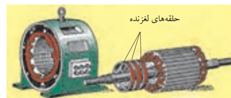
شکل ۱-۴۶- اجزای موتور روتور سیم‌پیچی
