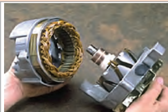
باز کردن مجموعه آلترناتور
