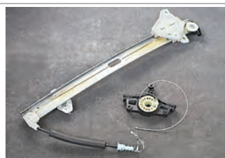
بررسی قطعات مکانیکی اهرم‌بندی (یا نوع سیمی)
