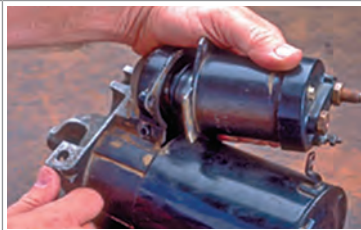
- خارج کردن اتوماتیک استارتر
