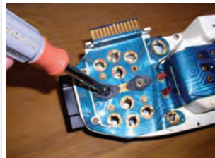
بازکردن مجموعه برد الکترونیکی
