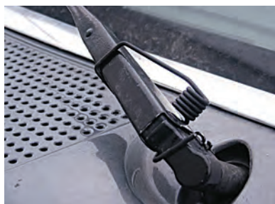
شکل ۹- ابزار افزایش فشار تیغه روی شیشه
