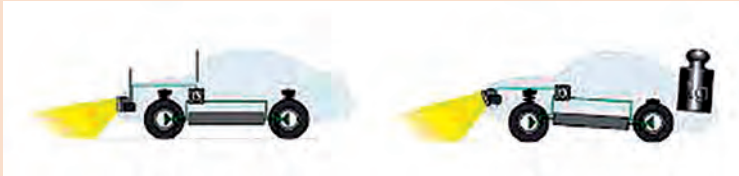
شکل ۲- دلیل تنظیم ارتفاع
