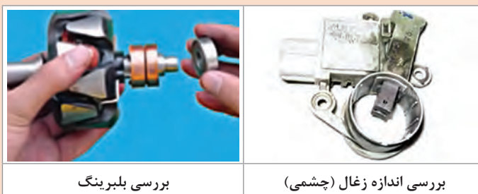
شکل ۳۲- روش بررسی اجزای آلترناتور
