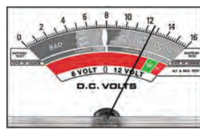
ولتاژ شارژ کمتر از حد است
