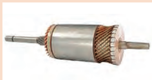
شکل ۳۴- دو نوع آرمیچر موتور استارت
