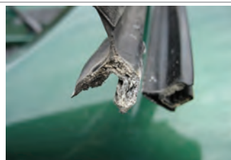
بررسی خرابی لاستیک آب‌بندی کنار شیشه
