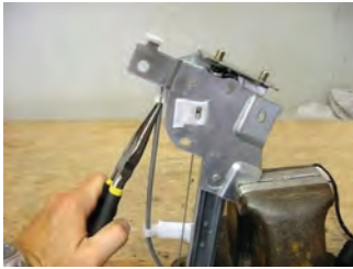
تنظیم قرقره و بست های تسمه
