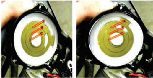
شکل ۱۲- مکانیزم برگردان تیغه (پارک)
