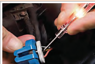
بررسی سیم پایه دارای برق (مثبت)
