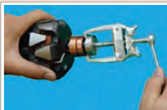
خارج کردن بلبرینگ جلویی از روی روتور
