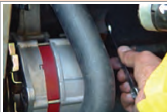
بازکردن پیچ‌های پایه آلترناتور
