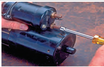
- باز کردن اتصالات اتومات استارت
