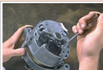
جدا کردن مجموعه رگولاتور و جا ذغالی
