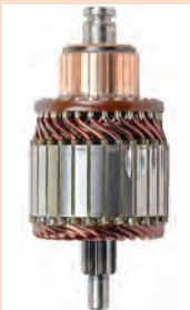
شکل ۳۴- دو نوع آرمیچر موتور استارت
