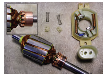
بررسی موتور شیشه بالابر از نظر کوتاه شدن زغال و فنر- سایدگی کلکتور- بوش‌ها - کانکتور
