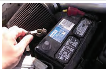
- جدا کردن اتصالات باتری
