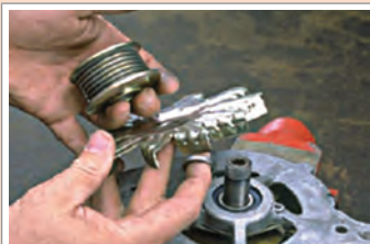
باز کردن پولی و پروانه
