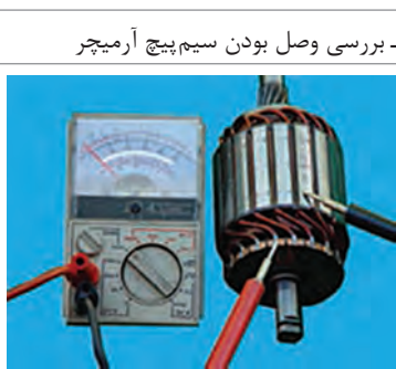
- آزمایش اتصال بدنه آرمیچر
