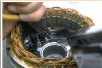
جدا کردن اتصال لحیم مجموعه دیود
