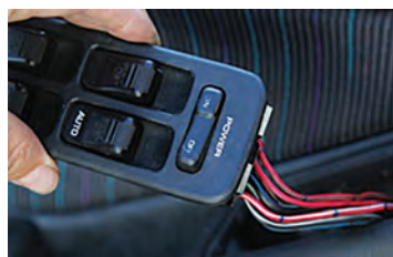
جدا کردن مجموعه کلید شیشه بالابر
