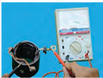
- آزمایش اتصال بدنه بالشتک‌ها
