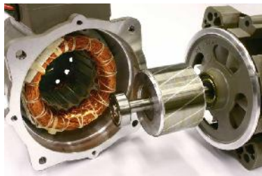
شکل ۱ - روتور و استاتور
