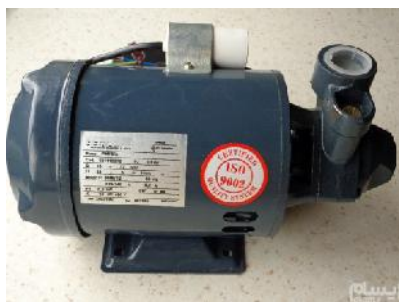
شکل ۲ - پمپ با خازن راه‌انداز
