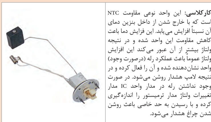
شکل ۶- ترمیستور واحد شناور مخزن سوخت
