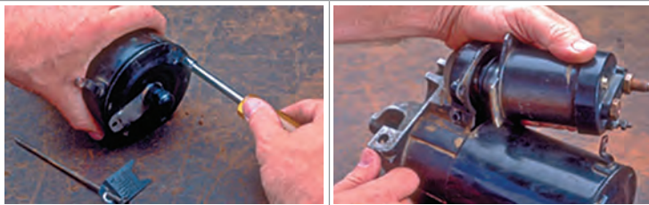
- باز کردن پیچ‌های اتصال درپوش به بدنه استارتر
