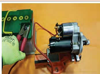
۲- قطب مثبت باتری را توسط یک کابل به ترمینال B اتوماتیک استارت اتصال دهید.
