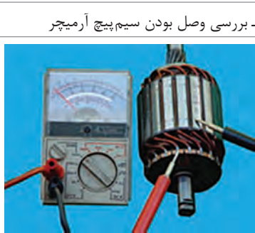
- آزمایش اتصال بدنه آرمیچر
