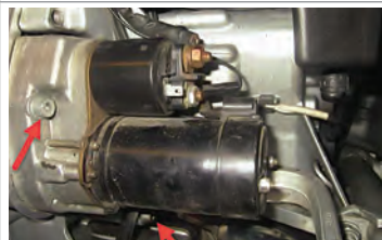
باز کردن پیچ‌های اتصال استارت به موتور.
