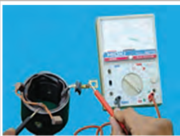
- آزمایش اتصال بدنه بالشتک‌ها
