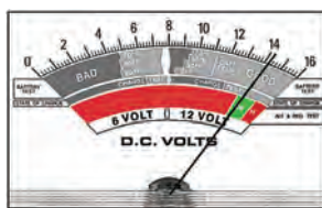
ولتاژ شارژ طبیعی است
