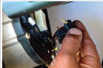
جدا کردن کانکتور آلترناتور
