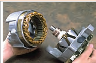
باز کردن مجموعه آلترناتور
