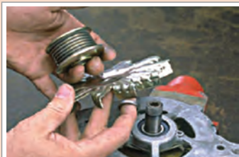
باز کردن پولی و پروانه
