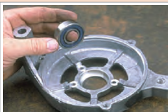
خارج کردن بلبرینگ عقبی
