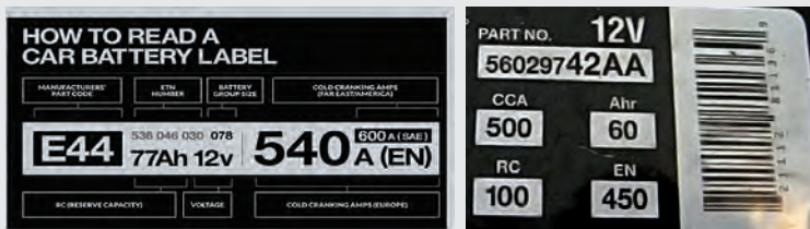
شکل ۱۳- دو نوع پلاک باتری و نحوه خواندن آن
