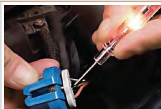
بررسی سیم پایه دارای برق (مثبت)
