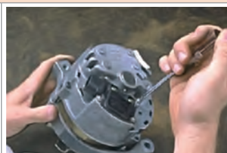
جدا کردن مجموعه رگولاتور و جا ذغالی
