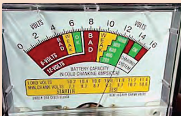
شکل ۱۶- نشان دهنده دستگاه تست باتری
