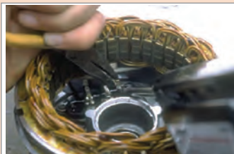
جدا کردن اتصال لحیم مجموعه دیود
