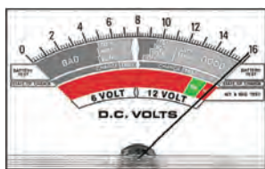
ولتاژ شارژ بیش از حد است
