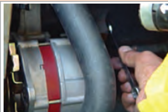
بازکردن پیچ‌های پایه آلترناتور
