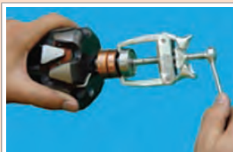
خارج کردن بلبرینگ جلویی از روی روتور
