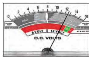
ولتاژ شارژ کمتر از حد است
