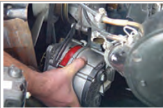
جدا کردن آلترناتور از روی خودرو
