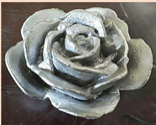
نمونه ریخته شده آلومینیومی در قالب‌های گچی که از مدل‌های مومی آماده در بازار درست شده است.
