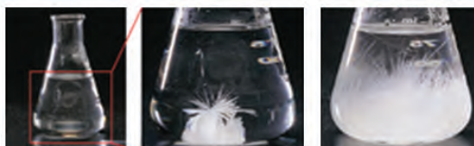
حل شدن نمک سدیم‌استات در آب و تشکیل بلور در اثر سرد شدن محلول
