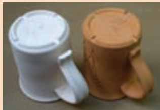
تأثیر اندازه ذرات در استون‌ور و پرسلان بر رفتار خشک شدن
