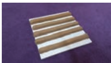
خارج کردن نمونه‌های استحکام خمشی خشک از قالب
