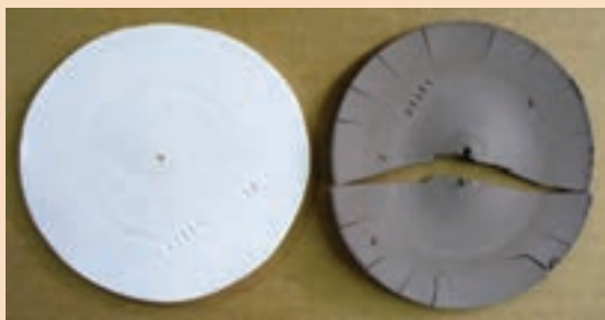
تأثیر شکل ذرات بر کیفیت سطح پس از خشک شدن
