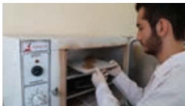
انتقال نمونه‌های انقباض به خشک‌کن و تنظیم دما
