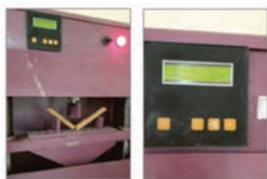
اندازه‌گیری استحکام خمشی خشک نمونه‌ها
