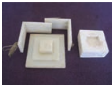
قالب و مادر قالب نمونه‌ساز انقباض
