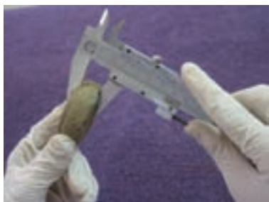
بررسی ارتفاع ۱۶ میلی‌متر در آزمون ففرکورن
