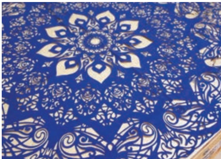
شکل ۹- ایجاد برش و طرح روی پارچه مصنوعی (کاربرد زینتی و پرده) با لیزر
