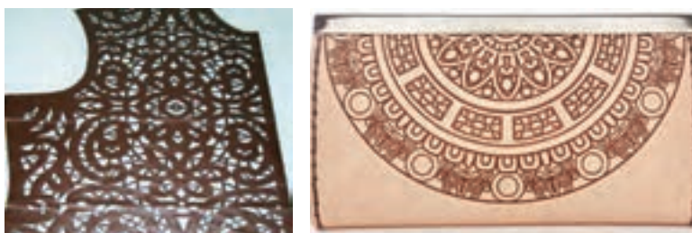
شکل ۷- ایجاد برش و طرح روی چرم با لیزر
