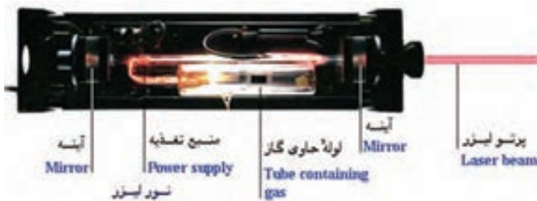
شکل ۱۴- ساختمان داخلی یک دستگاه لیزر
