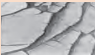
پدیده پوسته ای شدن توزیع نامناسب اجزای رنگ
