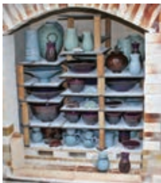
ب) قفسه‌بندی کوره برای پخت قطعات لعاب‌خورده
