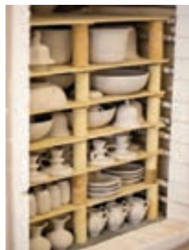
الف) قفسه‌بندی کوره برای پخت قطعات بیسکویت
