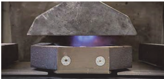
شکل (۱۱) پیش گرم کردن قالب‌های فلزی به وسیله مشعل‌های مجهز و کنترل شده دقیق
