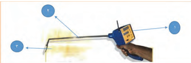
شکل (۲) ابزار اندازه گیری تماسی (ترموکوپل)
