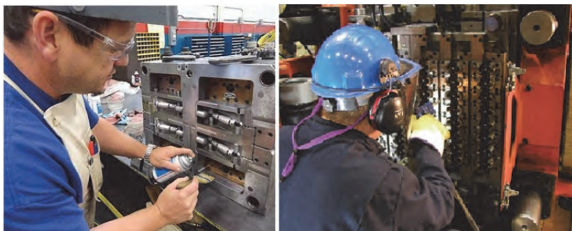
شکل (۹) تمیزکاری قالب‌های فلزی
