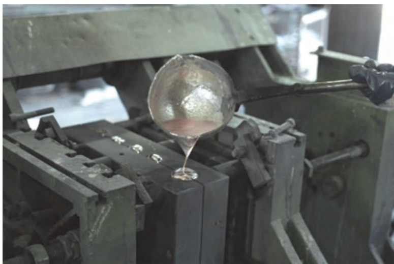
شکل (۱۸) قالب فلزی با نگه دارنده بازوهای مکانیکی
