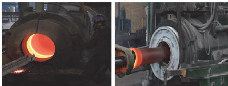
شکل (۷) ریخته‌گری گریز از مرکز
