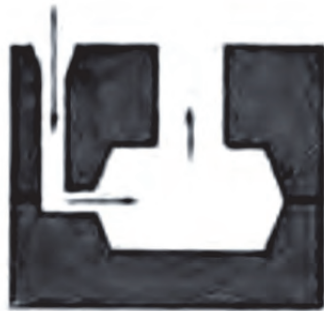
شکل (۸) سیستم راهگاه گذاری در سطح جدایش
