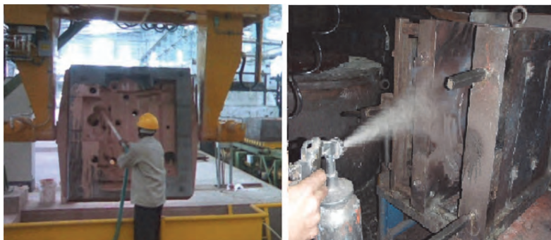
شکل (۱۳) پوشان کاری قالب با استفاده از اسپری
