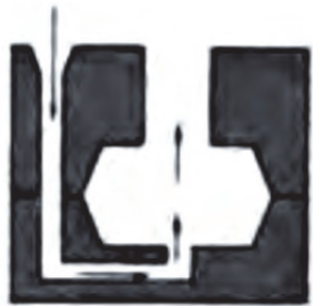
شکل (۷) سیستم راهگاهی از پایین
