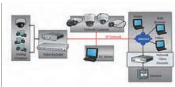
شکل ۳۷- معماری سامانه نظارت تصویری به همراه ویدیو دکدر برای نمایش در اتاق‌های نگهبانی
