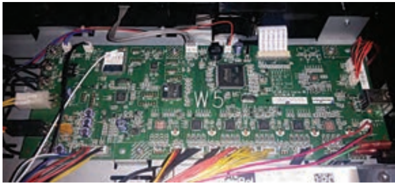
شکل ۲۱- برد اصلی دستگاه چهارکاره لیزری و اسیلاتور نصب شده روی آن
