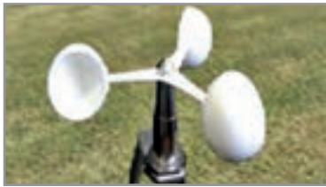
نوع فنجان‌ی با محور عمودی بر جهت جریان آب (cup type)
