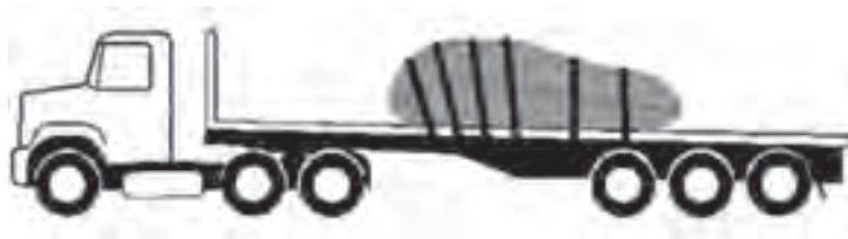
شکل ۲۱- نحوه استفاده از بند برای مهار کانتینرهای انعطاف پذیر
