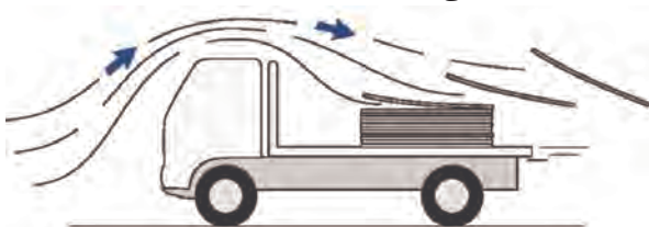
شکل ۸- جابه‌جایی بار در اثر سرعت حرکت بالا و وزش باد
