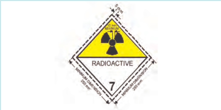
شکل ۹- شکل ابعاد و اندازه‌های برچسب نصب شده بر روی وسیله نقلیه
