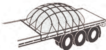
شکل ۲۲- استفاده از توری پوشاننده جهت مهار کانتینرهای انعطاف پذیر
