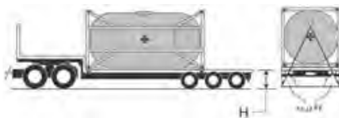
شکل ۳۴- بارگیری و حمل کانتینرهای تانکی بر روی نیمه‌یدک‌های کم ارتفاع
