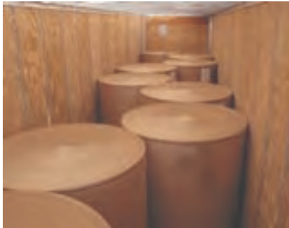
تصویر ۲۹- مهار رل‌های کاغذی به وسیله تکیه دادن به جداره‌ها
