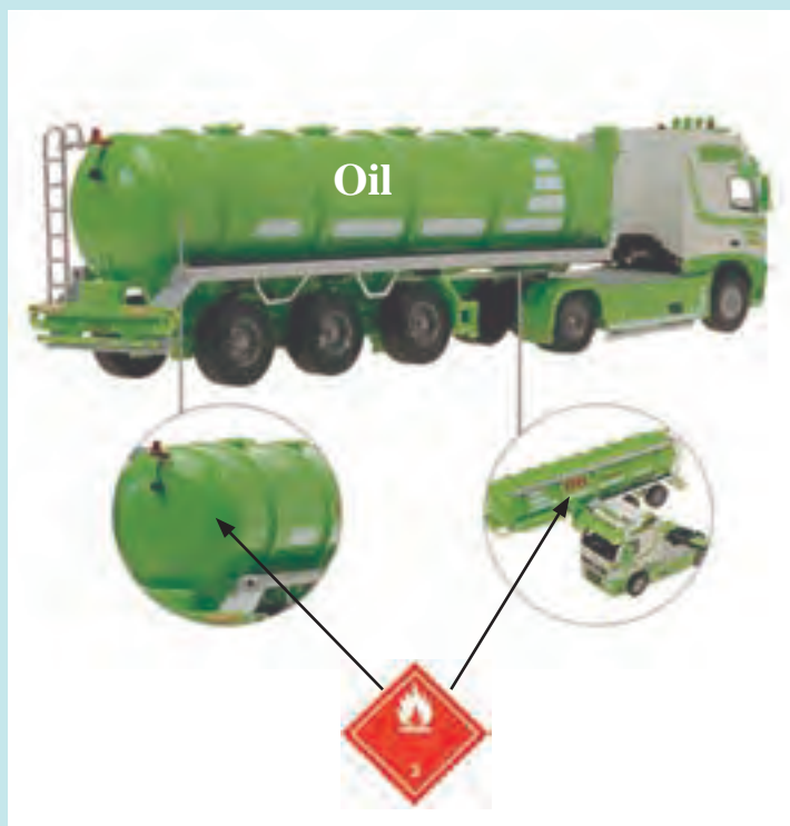
شکل ۸- محل نصب علائم مواد خطرناک بر روی ماکت وسیله نقلیه حمل مواد خطرناک
