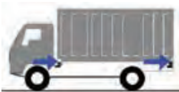
شکل ۱۸- بستن بار توسط قفل‌های پیچی در روش مهار افقی
