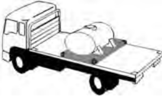
شکل ۲۴- تانکر مهار شده بر روی بارگیر توسط قفل‌های پیچی
