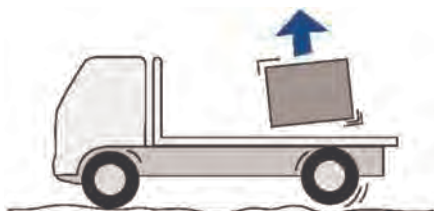
شکل ۹- جابه‌جایی بار در اثر ناهمواری‌های سطح جاده
