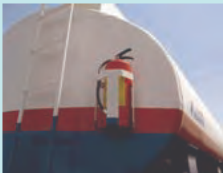
شکل ۶- محل نصب کپسول آتش‌نشانی پشت نفت‌کش
