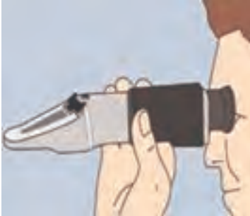
شکل ۳- طریقه استفاده از دستگاه اندازه‌گیری میزان شارژ باتری
