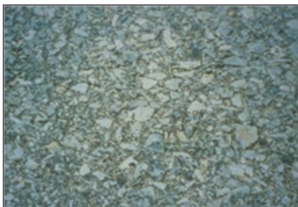
شکل ۶ - صیقلی شدن سنگ‌دانه‌ها
