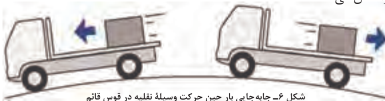
شکل ۶- جابه‌جایی بار حین حرکت وسیله نقلیه در قوس قائم
