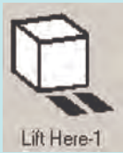
در صورت استفاده از لیفتراک از این قسمت بلند کنید.
