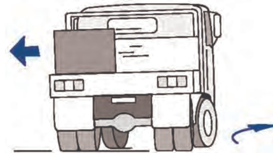
شکل ۵- جابه‌جایی بار حین حرکت وسیله نقلیه در قوس افقی
