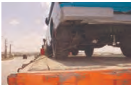
شکل ۲۷- نمونه‌ای از مهار نادرست یک اتومبیل
