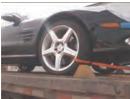
شکل ۲۶- نمونه‌ای از مهار صحیح یک اتومبیل
