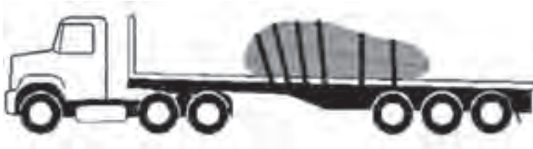
شکل ۲۱- نحوه استفاده از بند برای مهار کانتینرهای انعطاف پذیر
