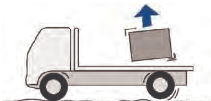
شکل ۹- جابه‌جایی بار در اثر ناهمواری‌های سطح جاده
