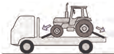
شکل ۱۹- بستن بار توسط بند در روش مهاری افقی
