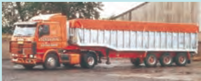
شکل ۳۸- نمونه‌ای از روکش برای حمل سنگ ریزه
